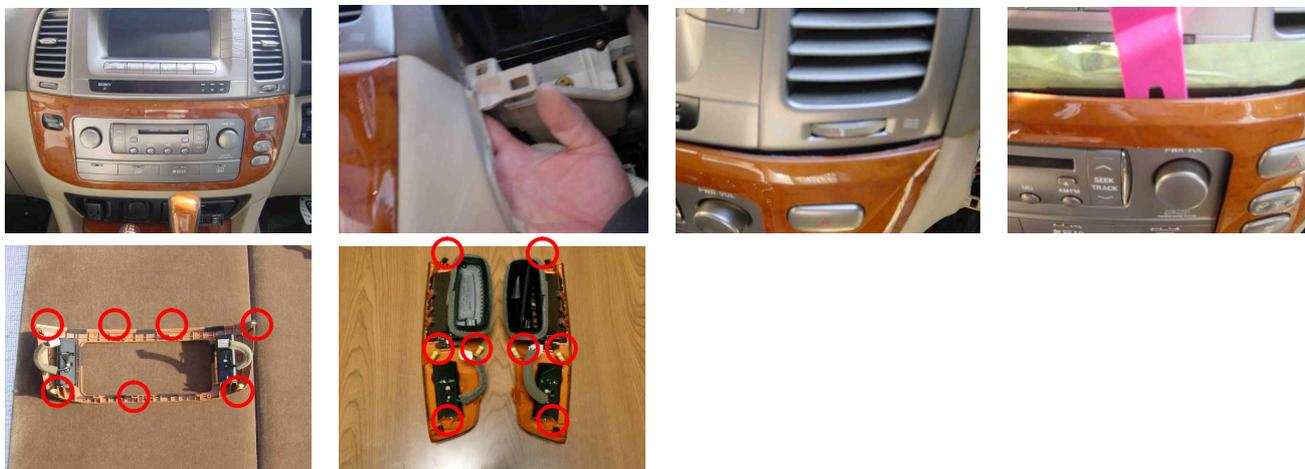
画像 2 枚目様に、センターコンソール裏側より、「インストールクラスタ フィニッシュパネル CTR」の、ピンを押す。(5 枚目画像の、左のピン)
