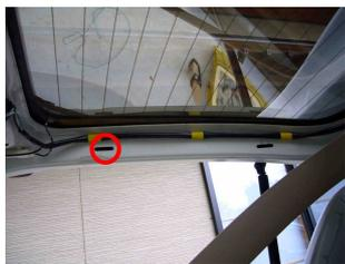
\* この部分より、針金等を左右に通し、車体ルーフ側よりカメラ配線（後方部）を引き込み、カメラ側（前方部）との、コネクターと接続する。
